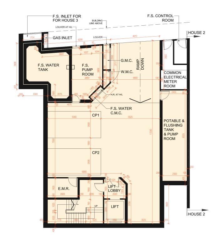
LOWER GROUND FLOOR PLAN 低層地下平面圖
