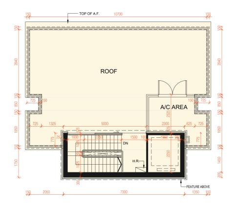
ROOF FLOOR PLAN 天台平面圖
