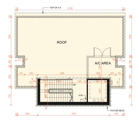
ROOF FLOOR PLAN 天台平面圖
